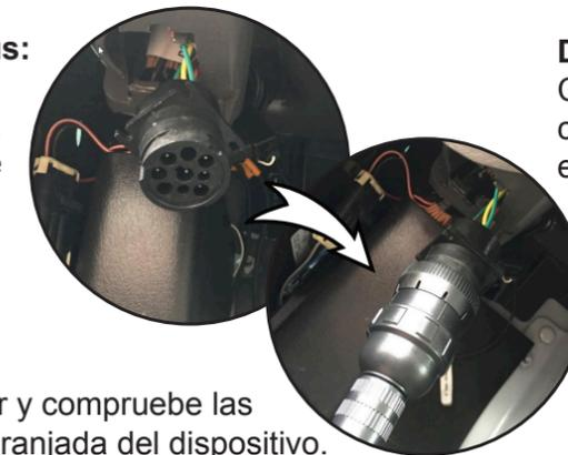
**Dispositivo OBD:** Conecte el cable OBD con el dispositivo, entonces enchufe el dispositivo en el puerto OBD II.
